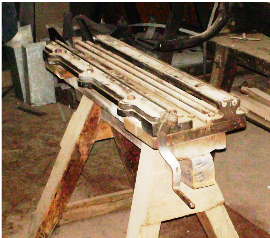
Maszyny Ojca. Wulstmaszyna – do zwijania brzegów blachy. (Foto 2010.08.20)
