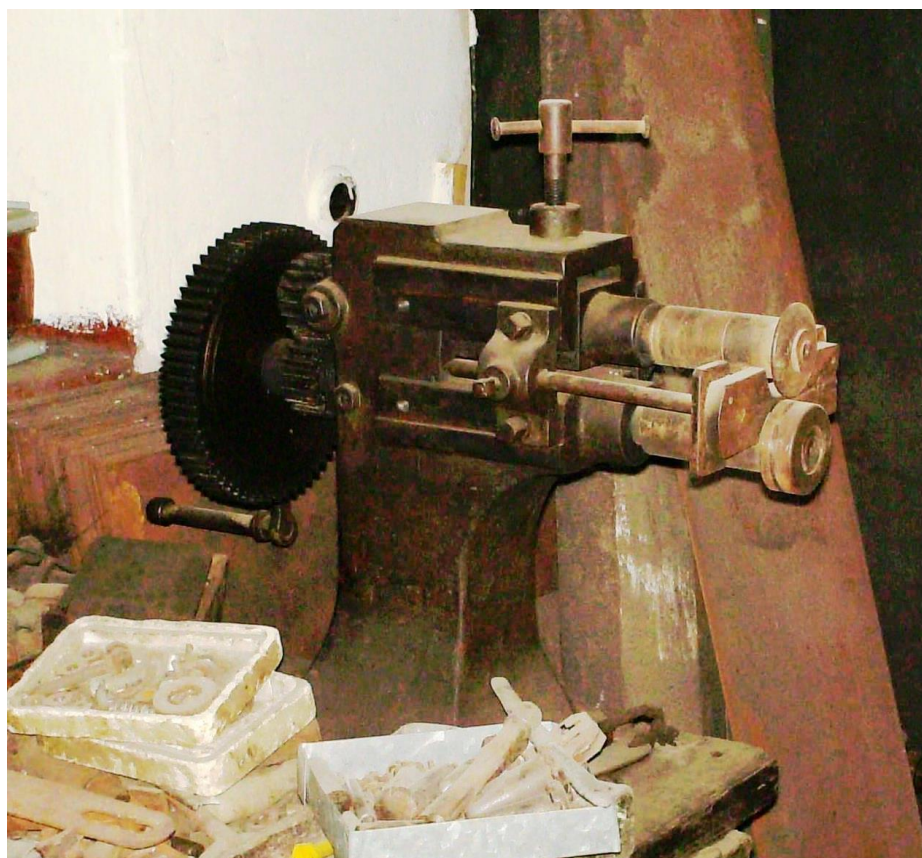
Maszyny Ojca. Zykmasyna – do wytłaczania brzegów blachy. (Foto 2010.08.20)
