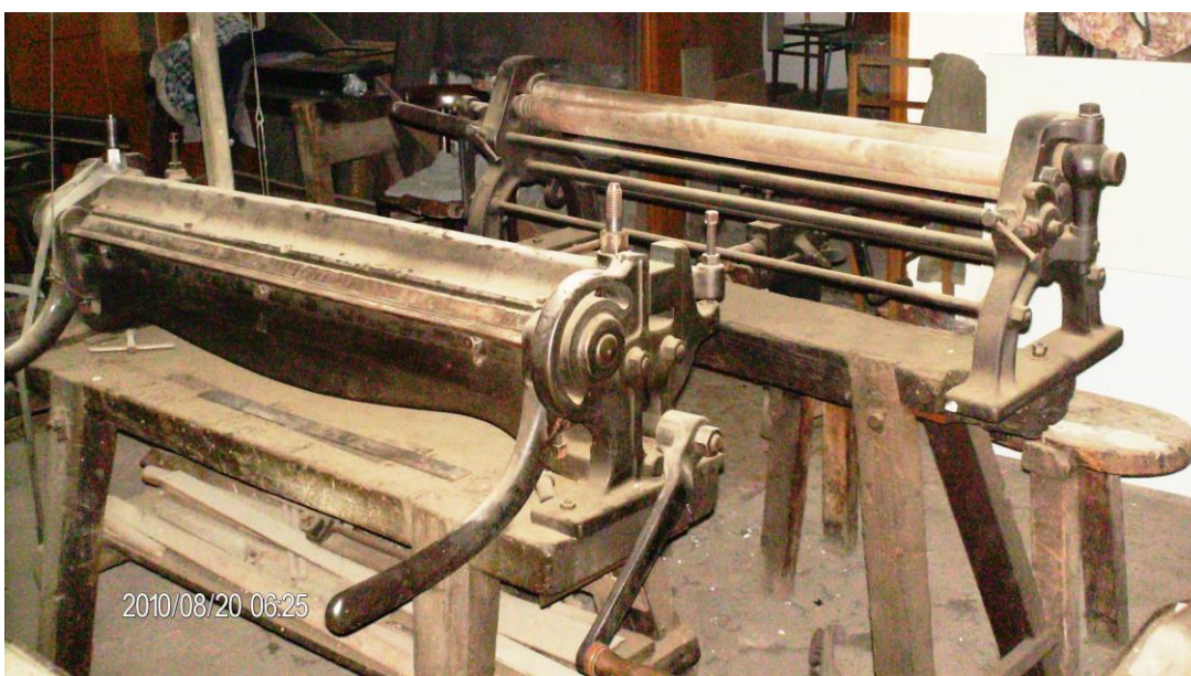
Maszyny Ojca. Kantmaszyna – do zginania blachy i rolmaszyna – do zwijania blachy. (Foto 2010.08.20)
